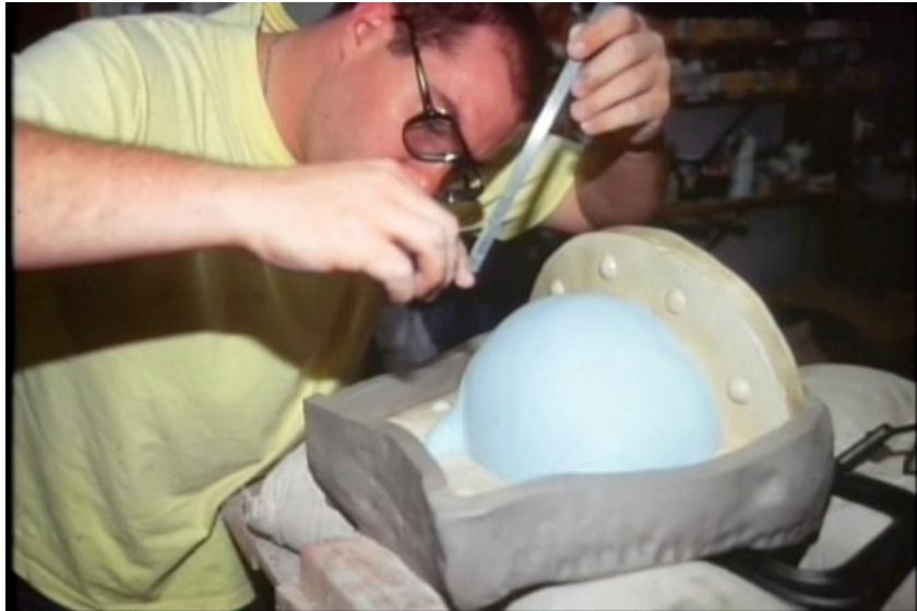
RESİM 19: Silikon kaplı modelin manto kalıbını almak için hazırlanırken.
