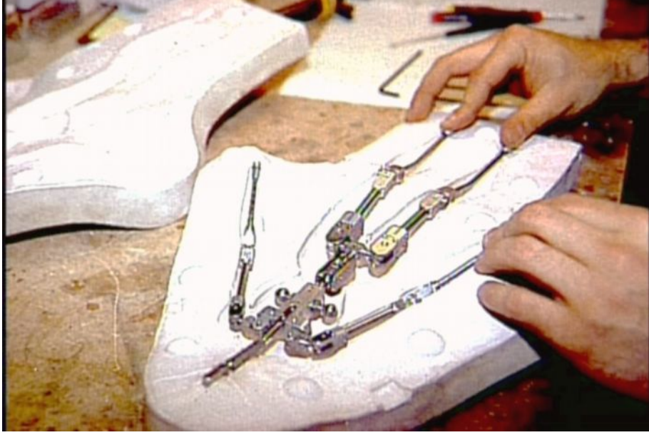
RESİM 20: İki parçalı alçı kalıba armatür yerleştirilirken.
