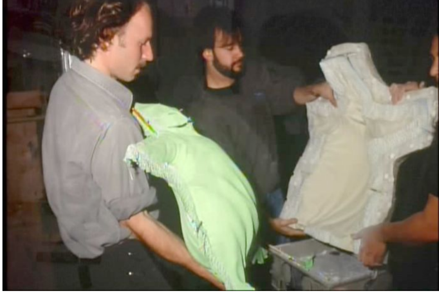
RESİM 24: Armatürlü köpük lateks kuklanın kalıptan çıkarılışı.
