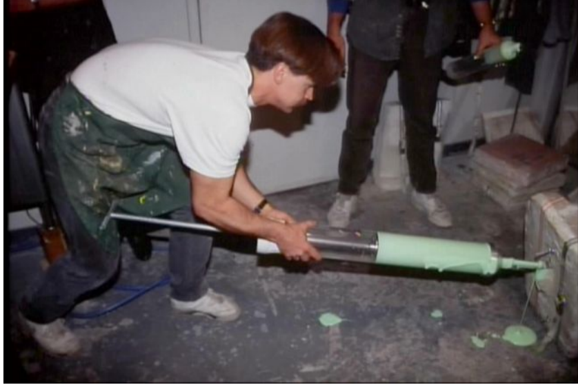
RESİM 22: Kalıbın iine kpk lateks sıkılırken.
