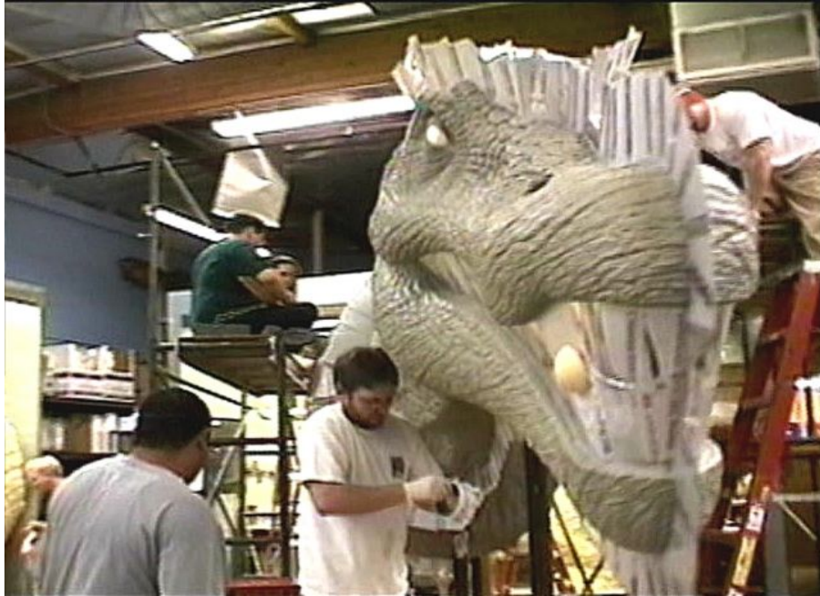
RESİM 30: Stan Winston Studio’da kil modelin kalıba hazırlanışı.
