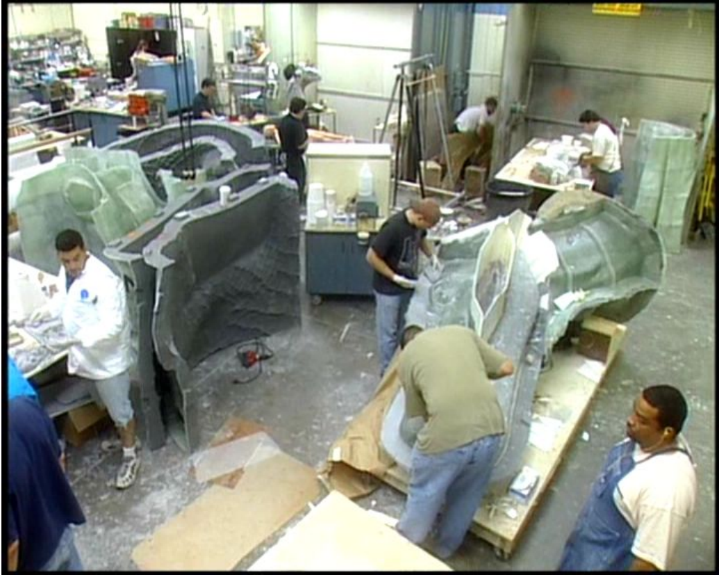
RESİM 31: Modelden elde edilen polyester kalıp parçaları.
