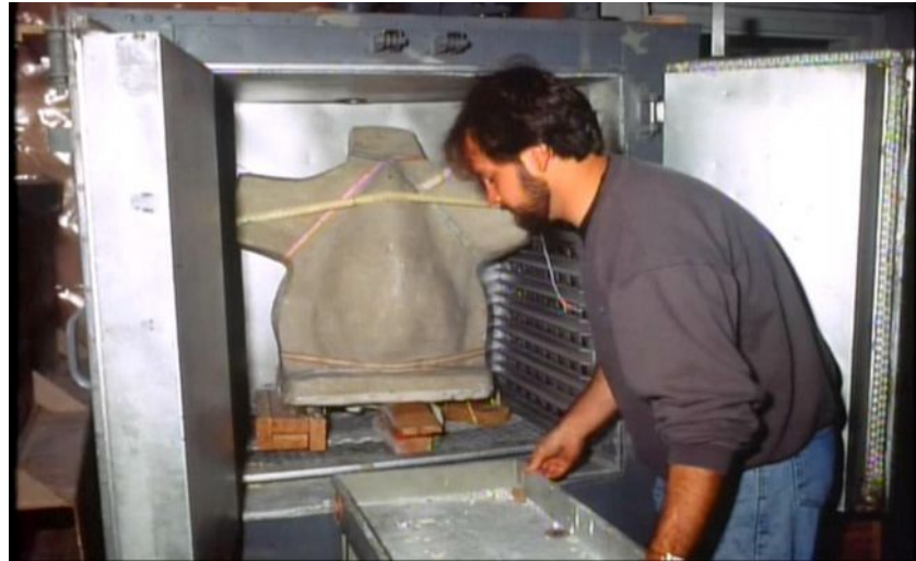
RESİM 23: Fırına yerleřtirilmiř kpk lateks dolu kalıp.
