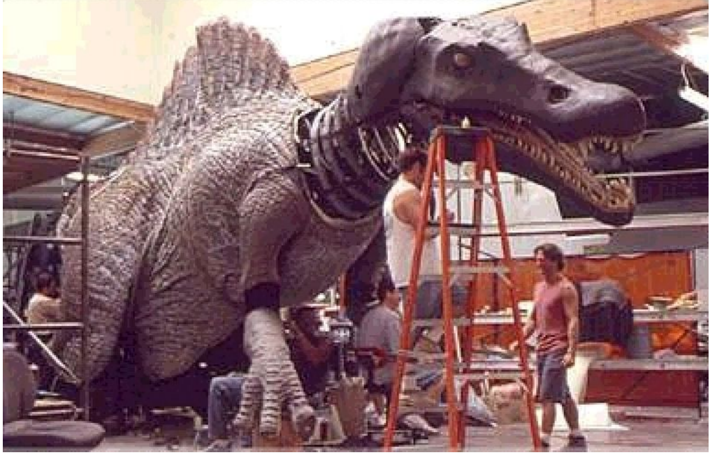
RESİM 32: Mekanik iskelet üzerine kaplamaların uygulanması.
